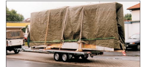
A - Grundtyp PHL 35.41 BT Sonderausstattungen: 3 Mittelrungen (0168H); Bordwände 300mm (1385C); Auflagebock (1377F); Beleuchtungsträger, ausziehbar(1380)
