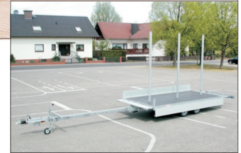
A - Grundtyp PHL 35.41 BT Sonderausstattungen: 3 Mittelrungen (0168H); Bordwände 300mm (1385C); Auflagebock (1377F); Beleuchtungsträger, ausziehbar(1380)
