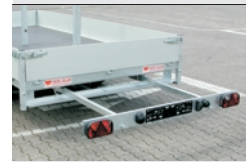
B - Grundtyp PHL 35.41 BT Sonderausstattungen: Anhängerladeschemel (1377E), Lkw-Ladeschemel, Bordwände 300 mm (1385C)
